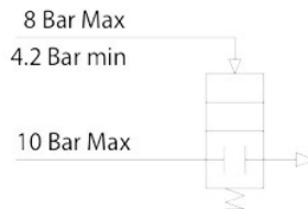
Schema di funzionamento nella configurazione semplice effetto normalmente chiuso Spring return Normally closed VIP Working plan
