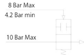
Schema di funzionamento nella configurazione semplice effetto normalmente aperto Spring return Normally open VIP Working plan
